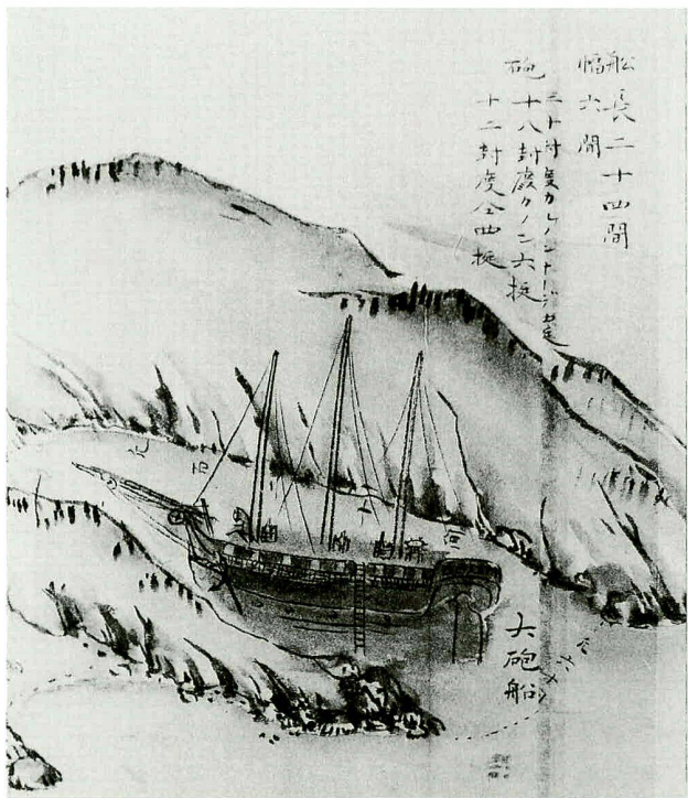
Bild 1: Der Bau eines Dreimasters nach westlichem Vorbild auf einer Schiffswerft in Satsuma, SüdJapan, im Jahr 1857; Länge 43,68m, Breite 10,92m, mit sechs 18-Pfund-Geschützen und vier 12-Pfund-Geschützen (Quelle: Zeitgenössische Darstellung in einer Serie von 26 Bildern mit Text, gezeichnet von Senjū Dainosuke aus Saga, betitelt Satsu-shū mitori ezu; im Besitz der Präpekturbibliothek Saga).
