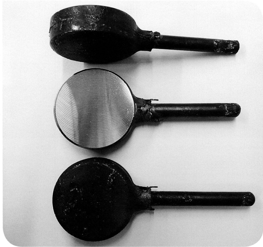
Bild 1: Stahlprobe mit und ohne Zunderschicht.
