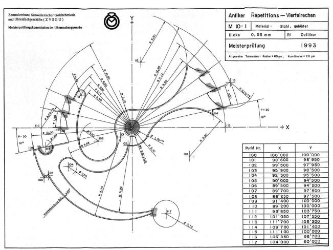
Bild 17: Plan eines Viertelstundenrechens. (Grafik: L. Oechslin)
