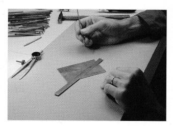
Bild 9: Risslinien auf dem Messingblech. (Foto: L. Oechslin)
