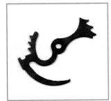
Bild 20: Fertiger Viertelstundenrechen mit altersbedingter Oxydation. (Grafik: L. Oechslin)
