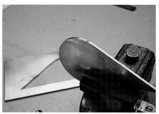
Bild 23: Nachbearbeitete Flanke des Teiles. (Foto: L. Oechslin)
