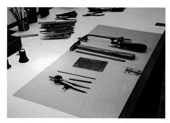
Bild 5: Anreisszirkel, Pointierstift, Anreissnadel, Messingplatte, Lineal, Hammer und Säge. (Foto: L. Oechslin)
