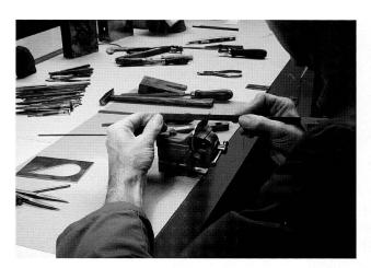
Bild 22: Nachbearbeitung mit der Schmirgellatte. (Foto: L. Oechslin)
