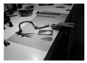
Bild 12: Ausgesägtes Teil. (Foto: L. Oechslin)
