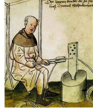
Bild 5: Mendelsches Hausbuch: Drahtzieher im Zangenverfahren, 1425/26. [Quelle: Stadtbibliothek Nürnberg, Amb. 317,2°]
