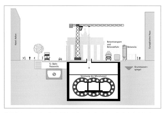
Bild 10: Vereisungskonzept zum Bau der U-Bahn-Station vor dem Brandenburger Tor, Berlin, Deutschland. (Foto: Herrenknecht AG)
