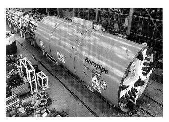
Bild 8: Europipe – Vortriebsmaschine bei Werkmontage, Schwanau, Deutschland. (Foto: Herrenknecht AG)
