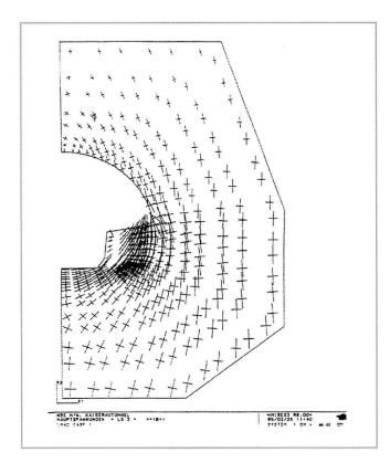
Bild 8: Kaiserau-Tunnel; hier nummerische Retroanalyse des Verbruchs durch die Lahmeyer International (Prüfingenieure). (Grafik: Wu/Rooney)<sup>47</sup>
