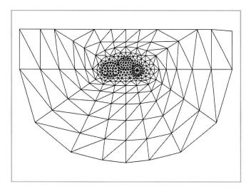
Bild 4: FE-Berechnung beim U-Bahn-Bau in München, 1979.  $\{Grafik: Swoboda\}^{26}$
