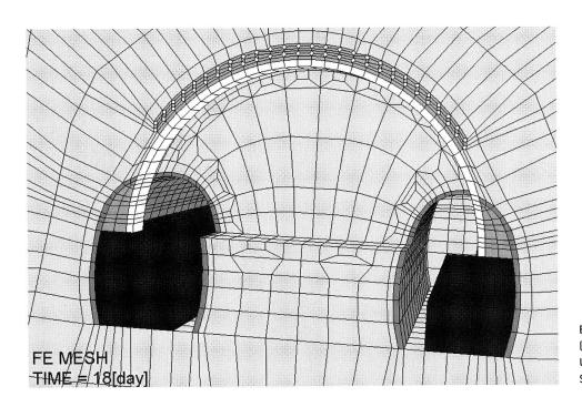
Bild 7: Z\_soil.PC von Zace Services (Lausanne); Simulation von Ulmenstollen, Kalottenvortrieb, Strossenabbau und Teilausbau.<sup>39</sup>
