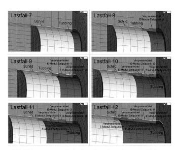
Bild 9: Finite-Elemente-Methode als ingenieurwissenschaftliches Forschungswerkzeug; nummerische Simulation eines Schildvortriebs mit ANSYS. (Grafik: Stahlmann)<sup>56</sup>
