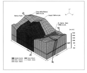
Bild 14: FE-Analyse von Stausee Sontga Maria und Gotthard-Basistunnel durch die Lombardi SA. (Grafik: Lombardi)<sup>78</sup>
