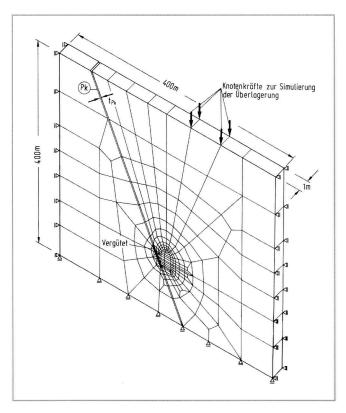
Bild 2: Elementnetz um Hohlraum und Kluft, Maschinenkaverne Wehr. (Grafik: Wittke et al. 1972–1974)<sup>19</sup>
