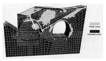
Bild 12: Dreidimensionale FE-Modellierung der Umgebung des Nordportals des Lötschberg-Basistunnels, lokal plastische Zonen in der Ortsbrust des Osttunnels, Emch + Berger AG, Bern. (Grafik: Straumann/Roggli/Ziegler)<sup>71</sup>
