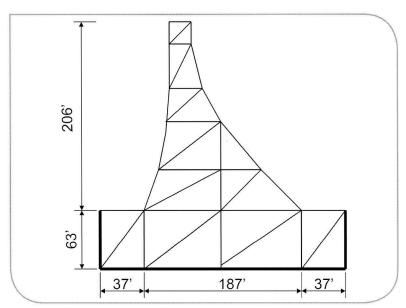
Bild 1: Finite-Elemente-Gitternetz für die statische Untersuchung einer Gewichtsstaumauer. (Grafik: Ray W. Clough 1960)<sup>1</sup>
