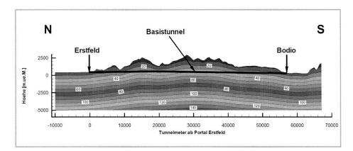
Bild 13: Kühlaggregat Piora-Zone, modelliertes Temperaturprofil entlang dem geplanten Gotthard-Basistunnel, vierfach überhöhte Darstellung. (Grafik: Busslinger)<sup>73</sup>
