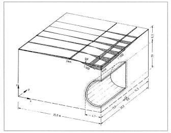
Bild 3a, Bild 3b: Setzungen der Geländeoberfläche, Stephan Semprich, 1980; a) ohne Verstärkung nach Ausbruch, b) mit Verstärkung. [Grafik: Semprich]<sup>21</sup>
