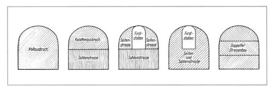
Bild 16: Verfahren beim Auffahren grosser Querschnitte.
