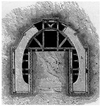
Bild 6: Deutsche Tunnelbauweise (Gewölbemauerung).
