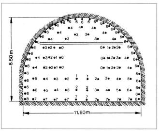
Bild 19: Sprengbild: 40-mm-Patronen, Profilsprengen.
