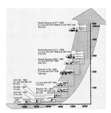
Bild 18: Leistungsentwicklung der Bohrarbeit (Atlas Copco).
