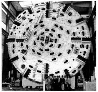
Bild 21: Vollschnittmaschine der Fa. Herrenknecht, 13,2 m Durchmesser.
