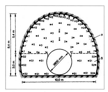
Bild 22: Kombinierter Spreng- und Maschinenvortrieb.
