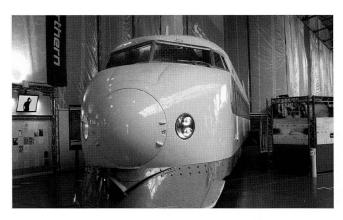
Bild 9: Triebkopf des Hochgeschwindigkeitszugs Shinkansen der ersten Generation um 1964. Der Triebkopf steht heute im National Railway Museum, York. (Foto: Kilian T. Elsasser)
