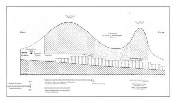
Bild 9: Titus-Tunnel von Çevlik (Türkei). Schema der Baustellenorganisation: Der Vortrieb erfolgte mittels zweier Suchstollen von aussen und über zwei weitere Suchstollen von einem Felseinschnitt im Mittelteil. (Foto: Klaus Grewe)
