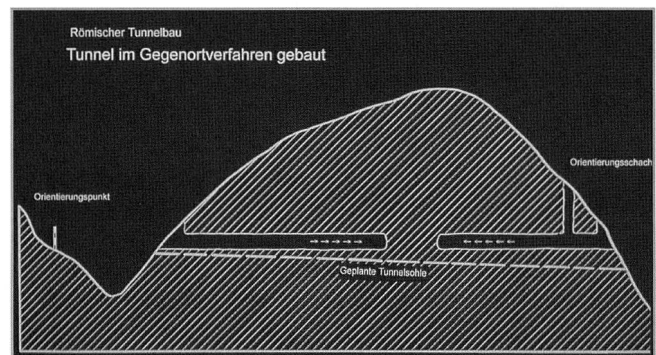
Bild 6: Eupalinos-Tunnel auf Samos. Schema der Richtungsübertragung in den Berg: Von Norden stand ein Gegenhang zur Vermarkung der Richtung zur Verfügung; im Südhang (Meerseite) war das nicht der Fall, hier diente ein Orientierungsschacht der Richtungsübertragung. (Foto: Klaus Grewe)
