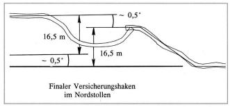
Bild 5: Eupalinos-Tunnel auf Samos. Im Treffpunktbereich schlägt Eupalinos im Vortrieb des nördlichen Bauloses einen «finalen Versicherungshaken», um das Südbaulos von der Seite sicher zu treffen. (Foto: Klaus Grewe)
