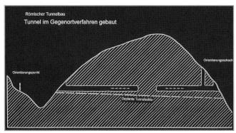
Bild 6: Eupalinos-Tunnel auf Samos. Schema der Richtungsübertragung in den Berg: Von Norden stand ein Gegenhang zur Vermarkung der Richtung zur Verfügung; im Südhang (Meerseite) war das nicht der Fall, hier diente ein Orientierungsschacht der Richtungsübertragung. (Foto: Klaus Grewe)
