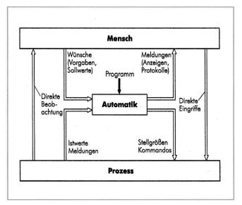
Bild 4: Kybernetische Komponenten eines automatisierten Prozesses.
