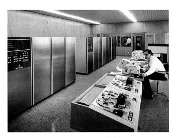
Bild 7: Doppelrechnersystem Siemens 3003 im Rohrwalzwerk Mülheim.
