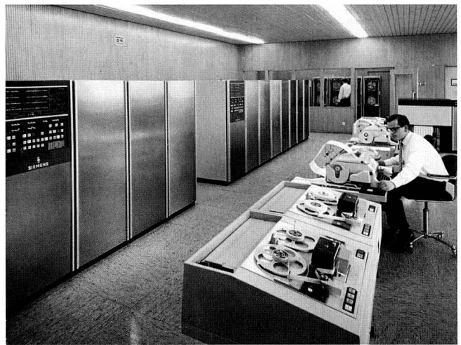
Bild 7: Doppelrechnersystem Siemens 3003 im Rohrwalzwerk Mülheim.
