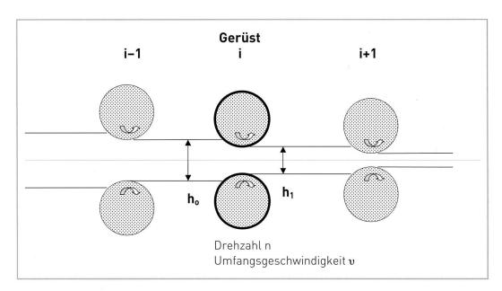
Bild 2: Steuerungsaufgaben an einem Walzgerüst.
