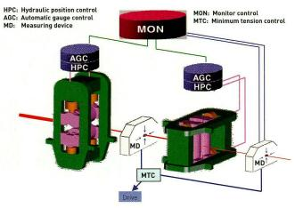
Bild 10: Regeltechnisches Masswalzsystem.
