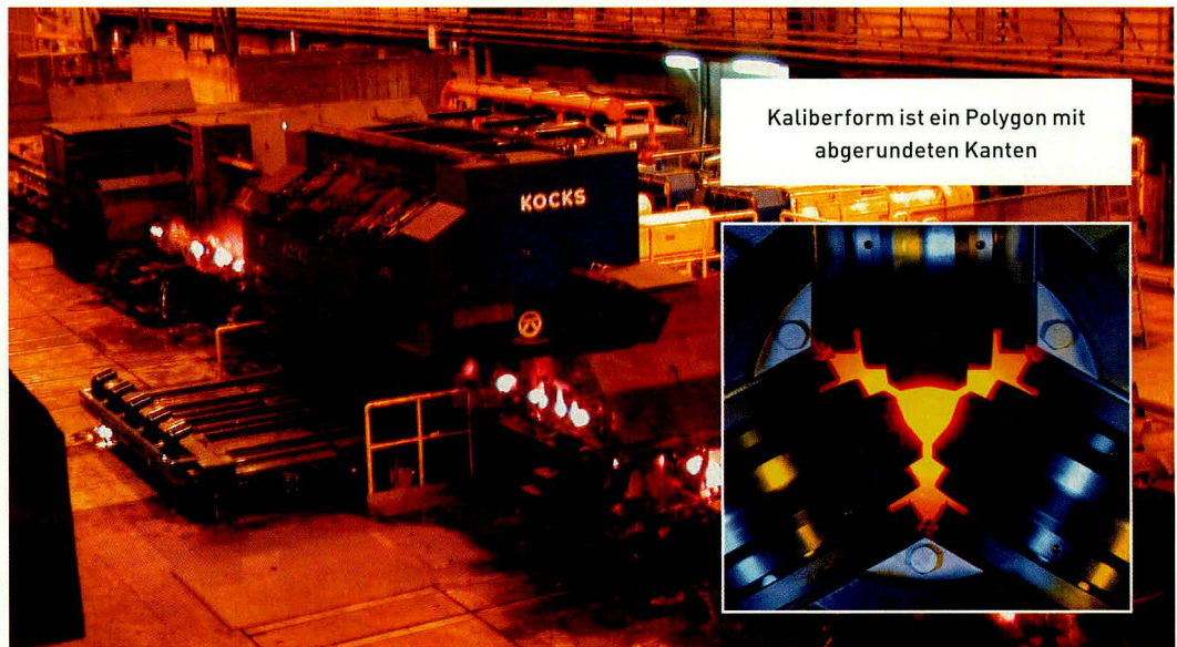
Bild 11: 3-Walzen Reducing und Sizing Block.
