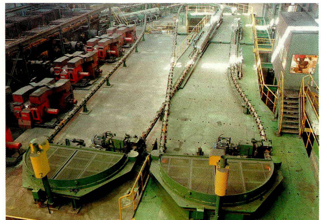
Bild 18: Temperaturregeltes Walzen mit Loop, Loops in der 2-adrigen Drahtstrasse der Voest-Alpine Austria Draht GmbH.
