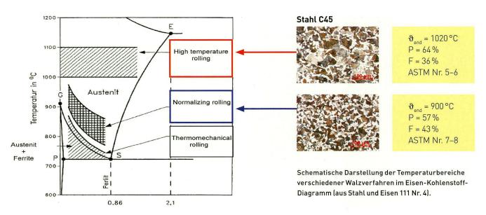
Bild 17: Hauptwalzverfahren des TMB.
