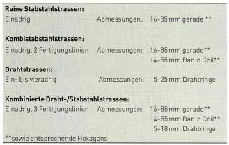
Bild 6: Bauweise und Abmessungsbereiche.
