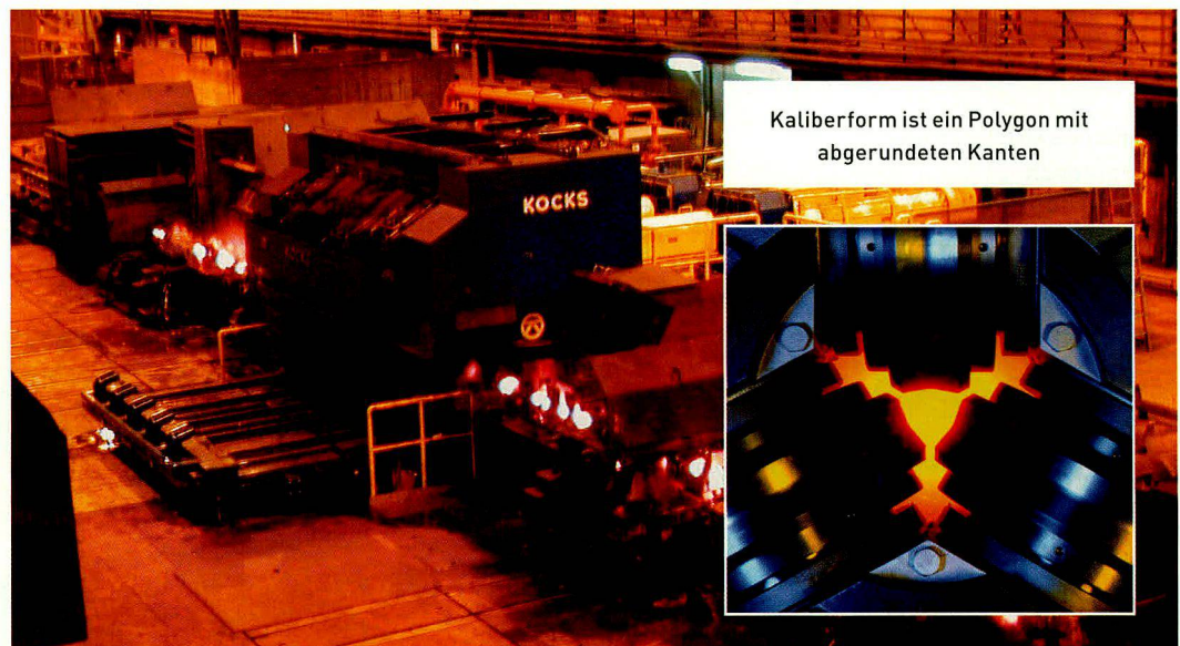
Bild 11: 3-Walzen Reducing und Sizing Block.
