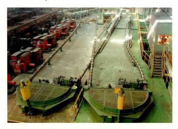
Bild 18: Temperaturgeregeltes Walzen mit Loop, Loops in der 2-adrigen Drahtstrasse der Voest-Alpine Austria Draht GmbH.
