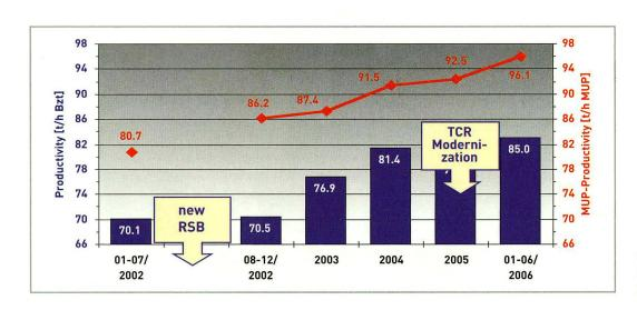
Bild 12: Vorteile des Dreiwalzenverfahrens (Beispiel von Moos Stahl).
