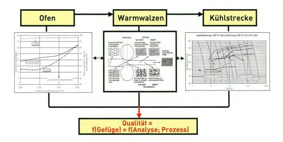
Bild 23: Modellierung und Simulation von Gefügeentwicklung.
