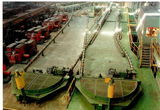
Bild 18: Temperaturgeregeltes Walzen mit Loop, Loops in der 2-adrigen Drahtstrasse der Voest-Alpine Austria Draht GmbH.
