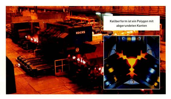
Bild 11: 3-Walzen Reducing und Sizing Block.
