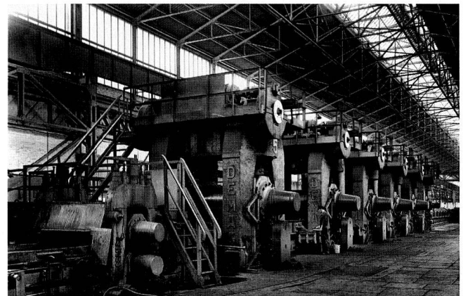
Zunderbrecher und 6-gerüstige Fertigstrasse, um 1937.
