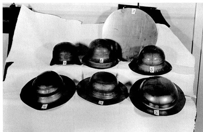
Tiefgezogene Helme aus Dinslakener Kaltblech, nach 1937.
