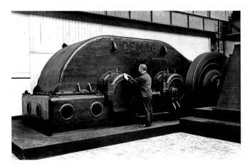
Getriebe eines Vorgerüstes der Warmbreitbandstrasse, 1937.
