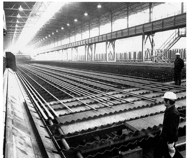
Bild 30: Kühlbett mit bis zu 160 m langen Rohren.
