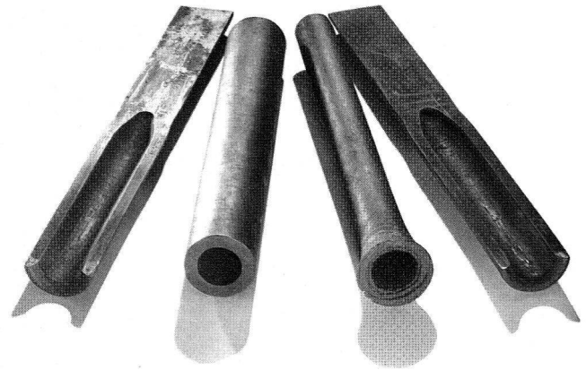
Bild 3: In der Nacht vom 21. auf den 22. August 1886 nahtlos gewalzte Stahlrohre (Deutsches Museum, München).
