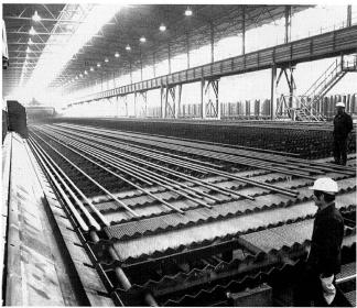
Bild 30: Kühlbett mit bis zu 160 m langen Rohren.
