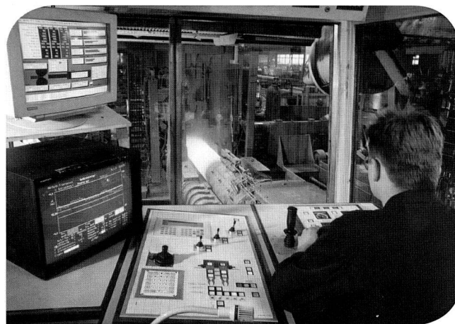
Bild 17: Klimatisierte Warte im Pilgerwalzwerk.
