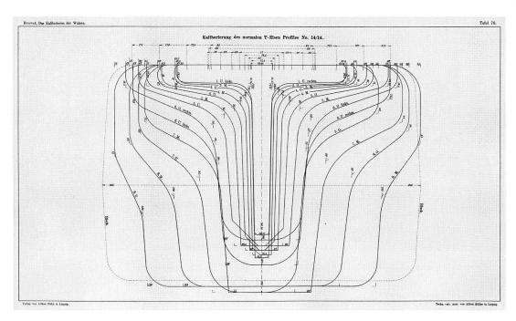
Kaliberierung des normalen T-Eisen Profiles No. 14/14.
