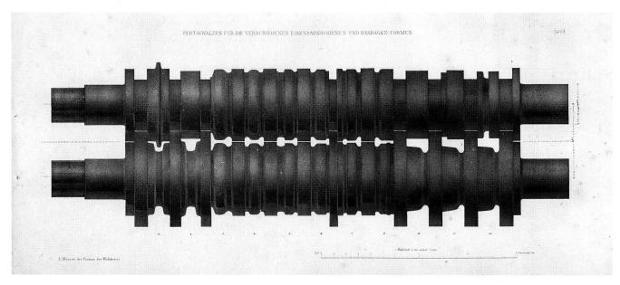
Fertigwalzen für die verschiedenen Eisenbahnschienen- und Bandagen-Formen.
