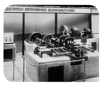
$\label{local-model} {\bf Modell~1:10~eines~der~ersten~elektrisch~betriebenen~Blockwalzwerke} in~Witkowitz/Vitkovice,~um~1910.$
