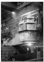
Abguss des 435 Tonnen schweren Der Schmiedeblock wird aus der Schmiede-Rohstahlblockes für Kokille gezogen (Bildnachweis:
