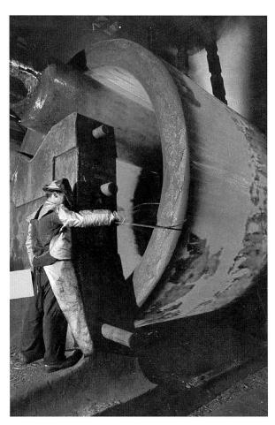
Schmieden eines Mantelschusses für das Reaktordruckgefäss des Kernkraftwerkes Gundremmingen unter der 6000-Tonnen-Presse; Schmiedemasse: 4120 mm äusserer Durchmesser, 3100 mm Länge, 86 000 kg Schmiedegewicht, Elektrostahl 20 NiMoCr 36, im Vakuum entgast, 1965 (Werbeschrift Rheinstahl Hüttenwerke. Für die Kerntechnik, undatiert, S. 6).
