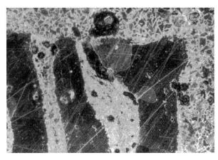
Abb. 16: Detailausschnitt des Damaszierungsmusters von Abb. 15.
