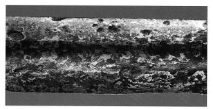
Abb. 3: Damaszierungsmuster und Korrosionslöcher der schmaleren Schwertklinge.
