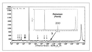
Abb. 12: Ergebnis der Röntgendiffraktometrie der breiteren Schwertklinge.
