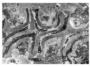
Abb. 15: Damaszierungsmuster der breiteren Schwertklinge bei lichtmikroskopischer Betrachtung.
