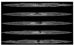
Abb. 10: Röntgen-Computertomographie-Aufnahmen der breiteren Schwertklinge.
