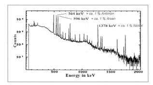
Abb. 11: Ergebnis der Gammaphotonen-Aktivierungsanalyse der breiteren Schwertklinge.
