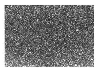
Abb. 17: Gefüge der schmaleren Schwertklinge im Bereich einer Schneidkante.
