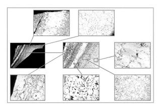
Abb. 20: Gefügevielfalt in dem Span der breiteren Schwertklinge.
