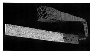
Abb. 4: Entstehung des Schweissdamastmusters (aus M. Sachse 1993).
