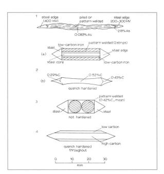
Abb. 6: Möglichkeiten des inneren Klingenaufbaus (aus R. Tylecote 1976).
