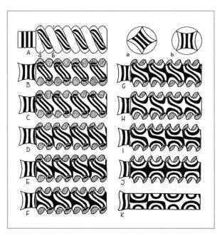
Abb. 5: Musterentstehung in Abhängigkeit vom Schleifabtrag (aus J. Ypey 1982).
