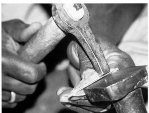
Abb. 36: Schmieden der Lamellen an der Ambosskante.
