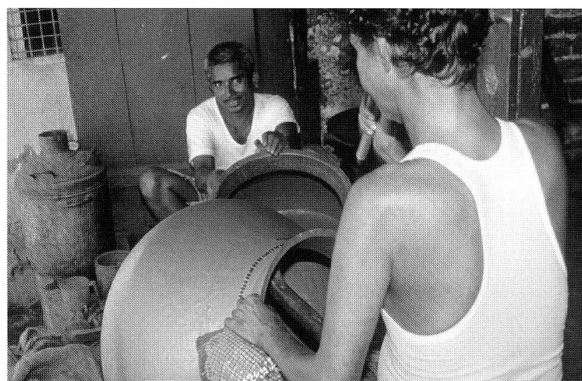
Abb. 28: Gebrauch der Treibfaust, der Schmied sitzt auf dem Ambossstock.
