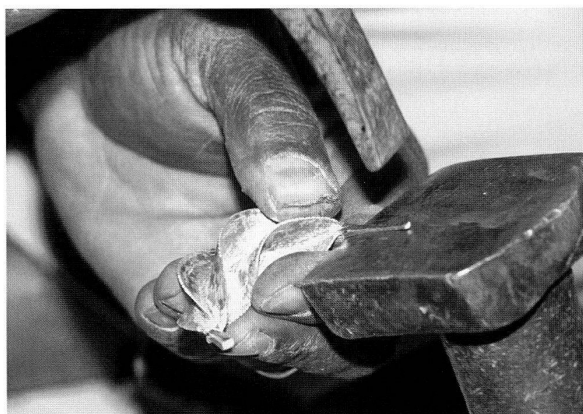
Abb. 39: Schmieden der Ohraufhängung.
