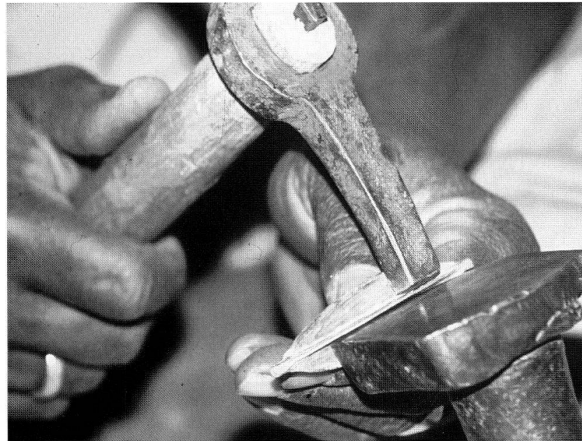
Abb. 36: Schmieden der Lamellen an der Ambosskante.
