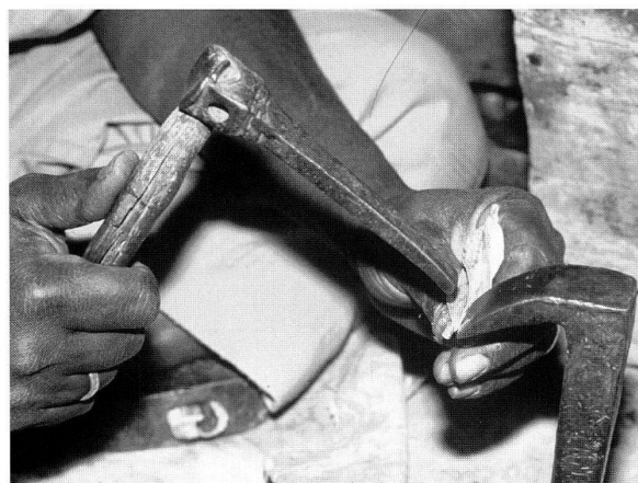
Abb. 38: Ausarbeiten der tordierten Lamellen mit einem schmalen, gerundeten Hammer und Amboss mit spitzem Winkel.
