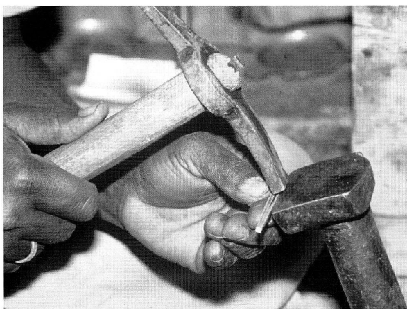
Abb. 35: Absetzen des Materials zwischen den gemeisselten Rillen.
