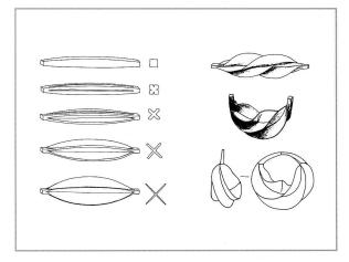
Abb. 34: Schema, Herstellung eines Ohrrings, vom Vierkantstab über den Stab mit kreuzförmigem Querschnitt zum tordierten Endprodukt.
