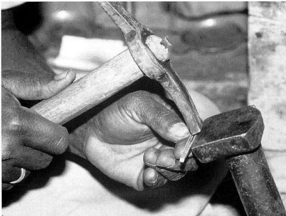
Abb. 35: Absetzen des Materials zwischen den gemisselten Rillen.
