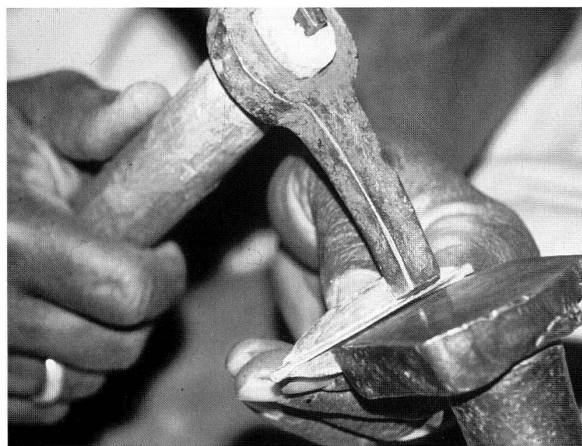
Abb. 36: Schmieden der Lamellen an der Ambosskante.
