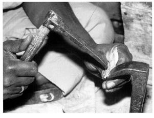
${\bf Abb.\ 38: Ausarbeiten\ der\ tordierten\ Lamellen\ mit\ einem\ schmalen,} gerundeten\ Hammer\ und\ Amboss\ mit\ spitzem\ Winkel.}$
