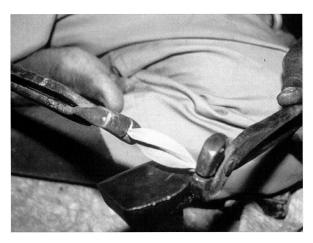
Abb. 37: Torsion mit Hilfe von zwei Zangen.
