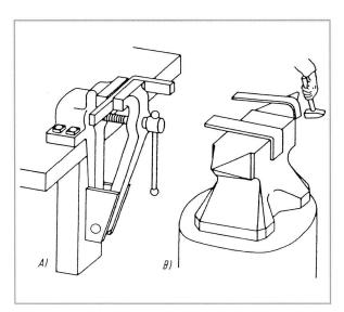
Biegen von kleinen, flachen Werkstücken. A) im Schraubstock biegen, B) über die Kante oder das Horn des Amboss biegen.
