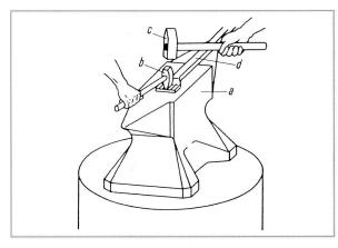
Breiten mit der Finne des Ballhammers auf dem Amboss. a) Amboss, b) Ballhammer, c) Zuschlaghammer, d) Schmiedestück.
