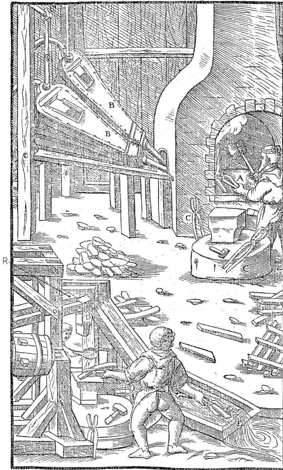
Aufwurfhammer mit Reitel nach Agricola, 1556.
