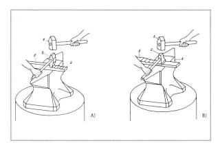
Recken und Schlichten auf dem Amboss. A) mit dem Ballhammer recken, B) mit dem Setzhammer schlichten, a) Amboss, b) Ballhammer, c) Setzhammer, d) Schmiedestück, e) Zuschlaghammer.
