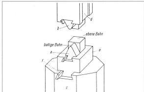
Sattel zum Recken und Schlichten unter Krafthämmern.
