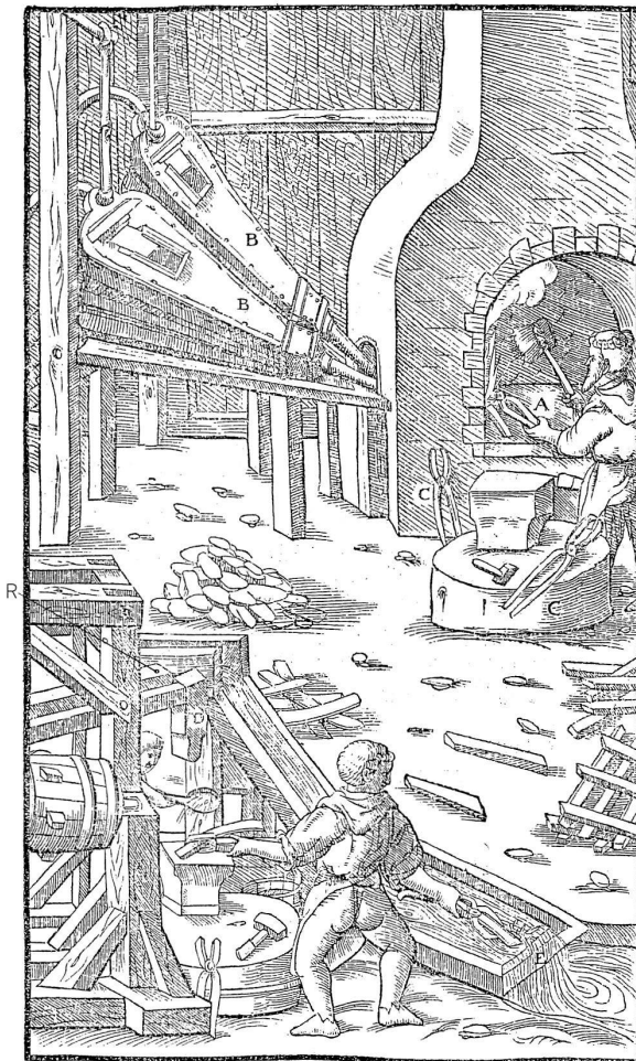
Aufwurfhammer mit Reitel nach Agricola, 1556.
