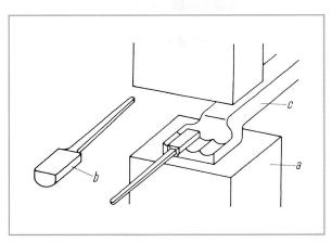
Breiten mit dem Balleisen unter Krafthämmern. a) Untersattel, b) Balleisen, c) Schmiedestück.
