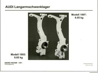
Reduzierung des Gewichts bei einem Längslenker.
