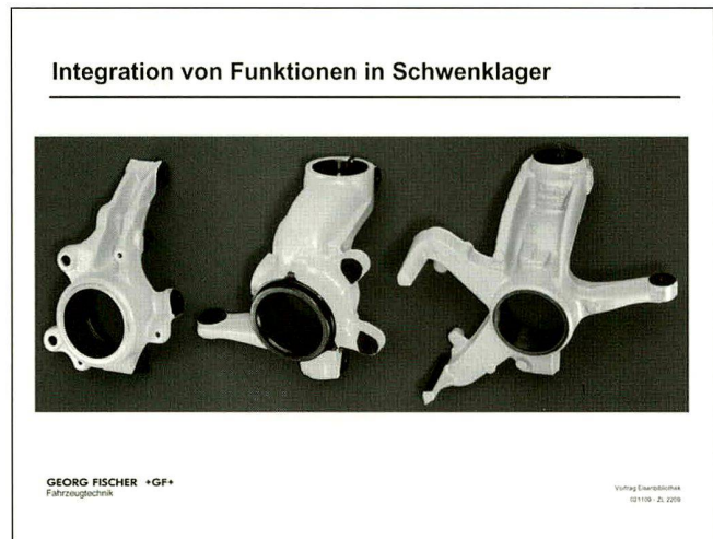
Entwicklungsstufen eines Schwenklagers.
