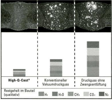
High-Q-Cast®-Produktqualität, demonstriert am Beispiel von Laserschweissnähten.
