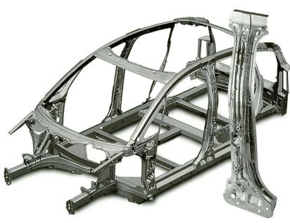
Audi A2 Space Frame mit den High-Q-Cast<sup>®</sup>-Druckgussteilen von Alcan BDW in der Legierung Aural-2<sup>®</sup>.
