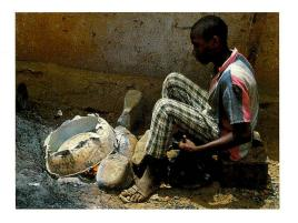
Ofen mit doppeltem Schalengebläse. Die Schalen bestehen aus alten Ölkanistern, die Bälge aus Plastikplanen.
