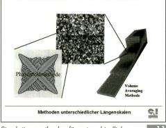
Simulationsmethoden für unterschiedliche Längenskalen (von rechts nach links: cm-Bereich, mm-Bereich (10 bis 1000 µm), µm-Bereich (< 10 µm).
