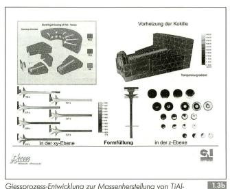
Giessprozess-Entwicklung zur Massenherstellung von TiAl-Ventilen (siehe Anm. 12).
