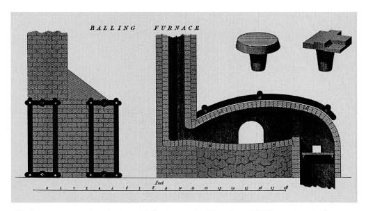
Abb. 4: Grundriss eines Puddelwerks und Balling Furnace (Puddelofen); aus: Neil Cossons, Hg.: Ress's Manufacturing Industry (1819 – 20). A selection from «The Cyclopedia; or Universal Dictionary of Arts, Sciences and Literature», Band 3; Newton Abbot 1972, Tafel 1, Fig. 1, und Tafel 2, Fig. 8 – 11, S. 202.f.
