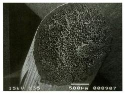
Abb. 10: Querschnitt eines Schilfrohres im Rasterelektronenmikrospkop: Die hohe Steifigkeit des Schilfhalmes wird durch eine Wabenstruktur erzeugt.
