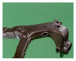
Abb. 2: Fahrwerksteil (MPV-Schräglenker) nach einer Schwingprüfung: Dank «weichen» Übergänge mit grossen Radien erfolgt der Bruch in der Prüfung nicht in der Anbindung des Arms.
