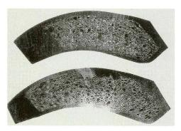
Abb. 12: Übertragung der Schilfstruktur in die Technik: Schaumaluminium.
