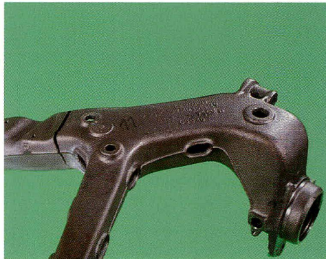
Abb. 2: Fahrwerksteil (MPV-Schräglenker) nach einer Schwingprüfung: Dank «weichen» Übergänge mit grossen Radien erfolgt der Bruch in der Prüfung nicht in der Anbindung des Arms.
