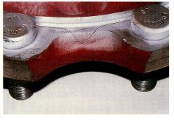
Abb. 17: Technische Lösung von Übergängen durch bearbeitete Radien am Beispiel einer LKW-Nabe nach einer Schwingprüfung: Bruchausgang in den Radien.
