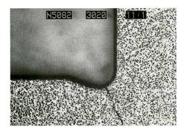
Abb. 18: Querschliff durch Bruchausgangsbereich einer Radnabe. Beim einem 1 mm-Radius trat der Bruch des Bauteils nach 239'000 Lastwechseln auf.
