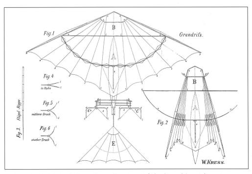
Zeichnung des Modells einer lenkbaren Flugmaschine mit zwei Luftschrauben und Gummischnurmotor von Wilhelm Kress (1880).
