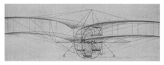
Zeichnung einer Flugmaschine mit schaufelradförmig angeordneten Flächen von Gustav Koch (1897).
