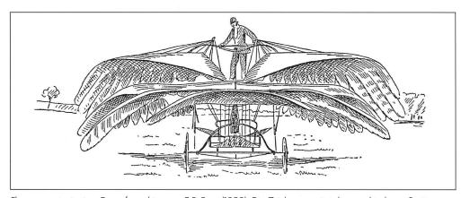
Flugapparat mit einer Dampfmaschine von E.P. Frost (1890). Die Zeichnung zeigt die verschiedenen Positionen beim Schlag der Krähen-Flügel.
