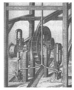
Abb. 2: Entwurf eines komplexen Pumpwerks mit Antrieb durch ein oberschlächtiges Wasserrad, im Vordergrund die Steigleitung (Ausschnitt, Salomon de Caus 1615).
