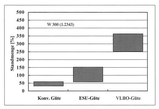
Abb. 12: Standmengenvergleich von unterschiedlich erschmolzenem Warmarbeitsstahlwerkzeug.
