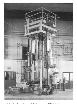
Abb. 1: Druck- und Schutzgas ESU-Anlage.
