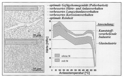
Abb. 9: Stickstofflegierte korrosionsbeständige 13 % Chromstähle.
