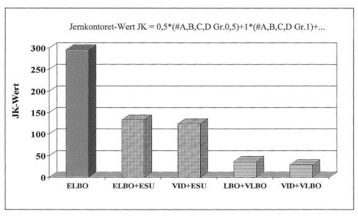
Abb. 7: Zusammenhang zwischen Schmelzroute und Reinheitsgrad bei dem Implantatstahl Bö A220SC.
