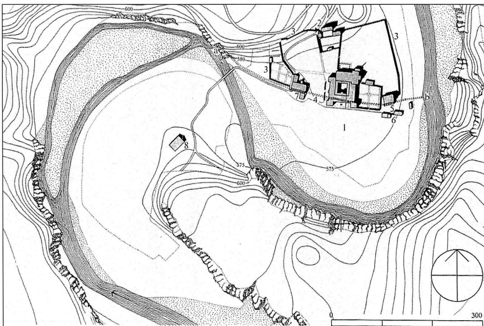
Für ein Zisterzienserkloster typische Lage: Hauterive in einer Flusskurve der Saane. – Legende: 1. Abtei; 2. Gebäude von St. Wolfgang; 3. Umfassungsmauer; 4. Abwasserkanal: a Einlauf, b Mündung; 5. Alte Mühle; 6. Nebengebäude; 7. Grangie; 8. Hof «La Souche» (aus: Waeber-Antiglio, Hauterive [wie Anm. 7], S. 25).
