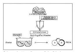
Schema der Herstellung von Rohcelluloid
