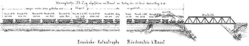
Der Festzug Sekunden vor der Katastrophe: hoher Andrang erforderte 13 Wagen und eine Vorspannlokomotive – hotte der erste Lokomotivführer durch eine unvorschriftsmässige Bremsung den Zug auf der Brücke zum Entgleisen gebracht? Rekonstruktion der Zugszusammenstellung 1891, Archiv VHS Luzern.
