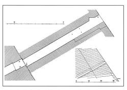
Abb. 8: Dahschur, Knickpyramide, Senkung des Ganges<sup>30</sup>
