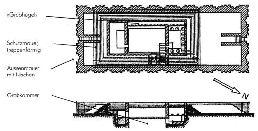
Abb. 2: Querschnitt und Grundriss einer Mastaba der 1. Dynastie<sup>10</sup>
