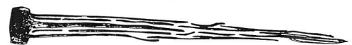
Bild 18: Bergmännisches Hauwerkzeug (Fimmel) mit wegkorrodierten aufgekohlten Härtegefügezeilen und wenig korrodierten damastartigen, unlegierten weichen Eisenbereichen (Zeichnung), gefunden im Schmiedebereich der Trachsellaunener Verhüttungsanlage (mikrobielle Korrosion)
