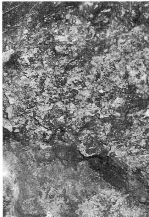
Bild 11: Blei- und Bleioxidinfiltrationen im gesinterten Herdmaterial des Flammofens
