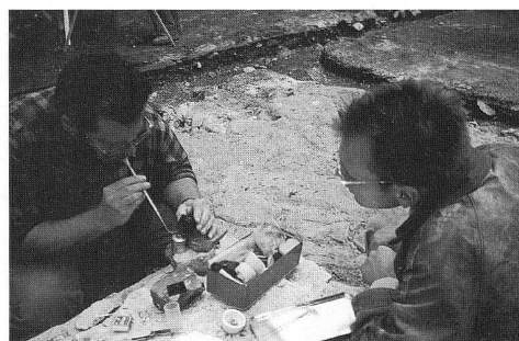
Bild 12: Reduktionsversuch von Bleioxid im Herdmaterial zu Blei mit dem Lötrohr
