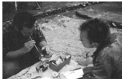
Bild 12: Reduktionsversuch von Bleioxid im Herdmaterial zu Blei mit dem Lötrohr
