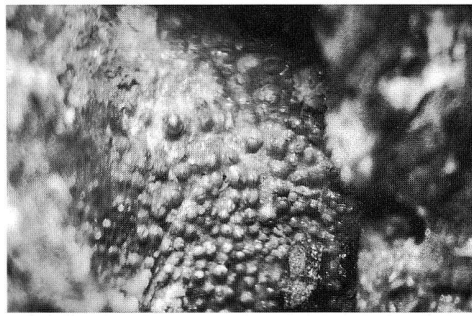
Bild 21: Karbonatische Zinkkondensate (Ofengalmei) am Gewölbematerial des Flammofen-Rösthofes (Mikroaufnahme)
