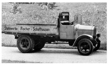
Bild 6: Simplex-Räder auf Georg Fischer Arbenz-Versuchswagen.
