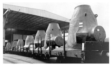
Bild 15: Pumpengehäuse à 30 Tonnen Gewicht für Nuklearkraftwerke beim Abtransport auf dem Ebnat in Schaffhausen (1977).
