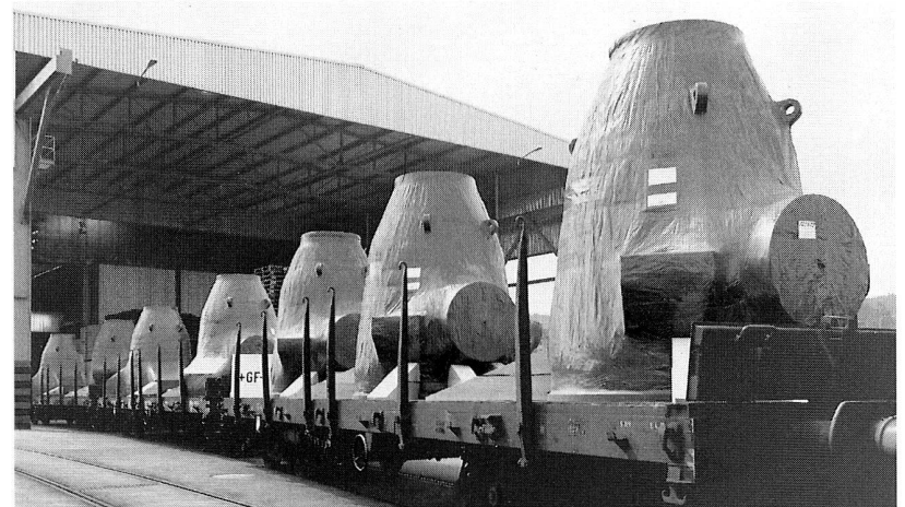
Bild 15: Pumpengehäuse à 30 Tonnen Gewicht für Nuklearkraftwerke beim Abtransport auf dem Ebnat in Schaffhausen (1977).
