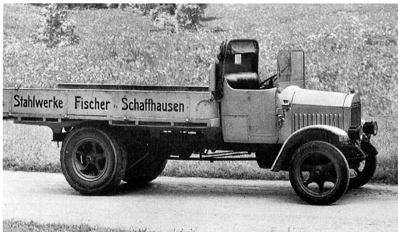
Bild 6: Simplex-Räder auf Georg Fischer Arbenz-Veruchswagen.
