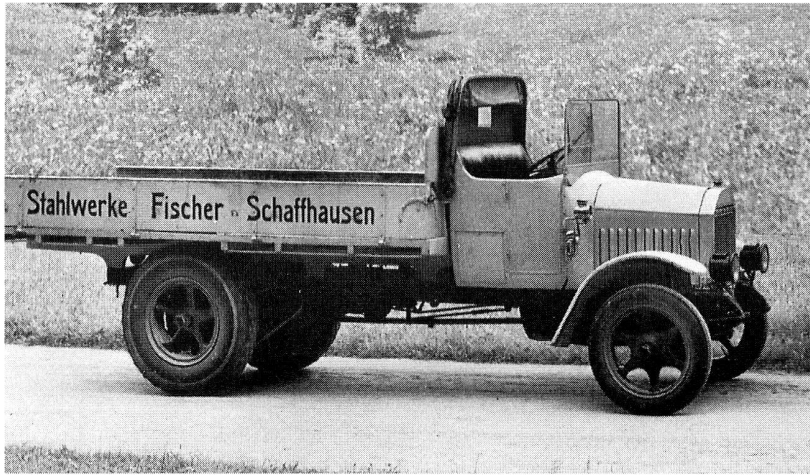
Bild 6: Simplex-Räder auf Georg Fischer Arbenz-Veruchswagen.
