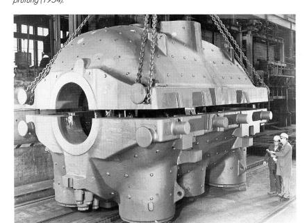
Bild 14: Dampfturbinengehäuse, 12 % Chromstahl (zirka 200 Tonnen). Jede Hälfte zusammengeschweisst aus zwei rund 45-Tonnen-Stücken.
