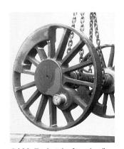
Bild 2: Triebräder für schnell fahrende Lokomotiven (1898).
