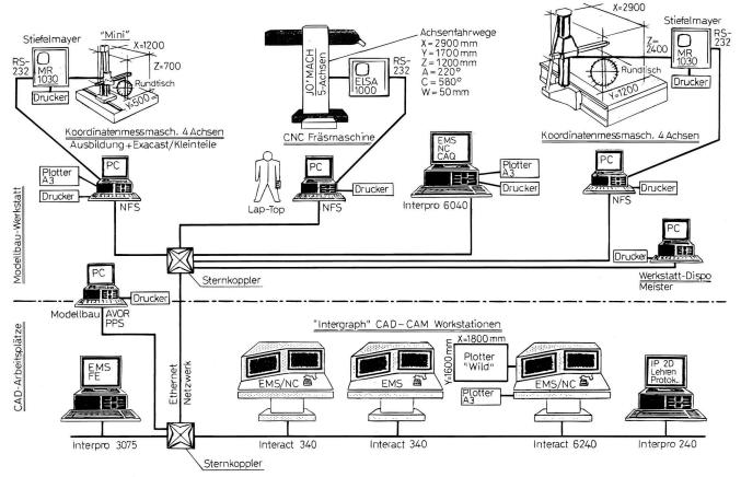
Bild 18: CAM-Netzwerk im Modellbau (CAD-CAM-CAQ).
