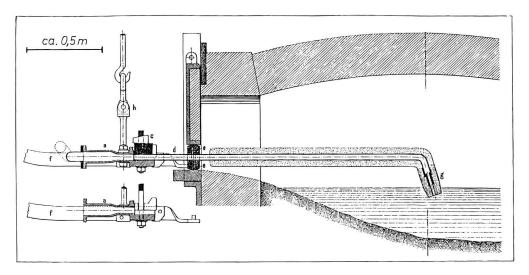
Bild 2: Duisburg-Ruhrort. Düse zum Einblasen von Luft (Wind) in das Bad im Siemens-Martin-Ofen von oben (Längsschnitt); sog. Würtenbergers Düsenapparat, um 1879/90. Aus: F. Kupelwieser: Studien...
