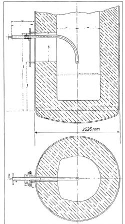
Bild 4: Gerlafingen. 2,5-t-Konverter mit wassergekühlter, gekrümmter Düse zum senkrechten Sauerstoffaufblasen auf ein Roheisenbad; L. von Roll'sche Eisenwerke, 1948. Aus: H. Hellbrügge: Die Sauerstoffanwendung...
