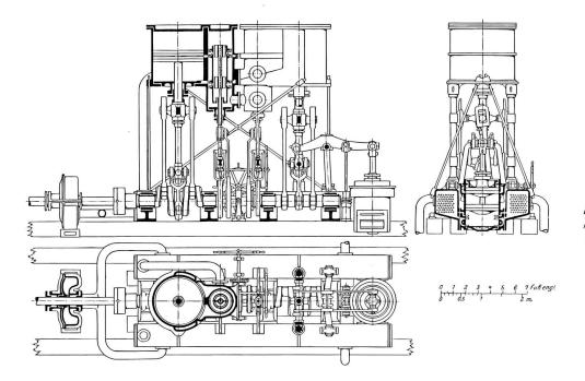
Doppelkolben-Dampfmaschine von J. G. Bodmer, 1845. Sulzer-Ventildampfmaschine, konstruiert 1865 von Charles Brown senior.
