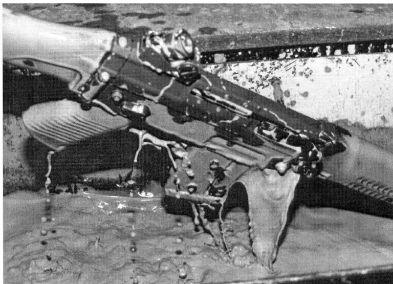
Bild 13: Sturmgewehr 90 im Schlammtest.
