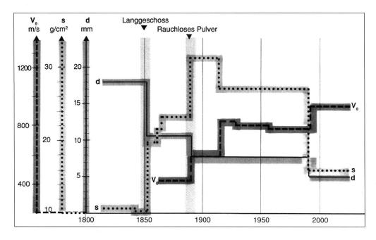
Bild 10: Entwicklung von Kaliber d (mm), Querschnittsbelastung s (g/cm²) und Anfangsgeschwindigkeit V<sub>0</sub> (m/s).
