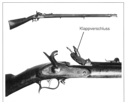
terlader mit Klappverschluss nach System «Milbank-Amsler» umzubauen (Bild 8). Die Schiesskadenz liess sich damit von 3 Schuss/min auf 7 bis 12 Schuss/min steigern.
