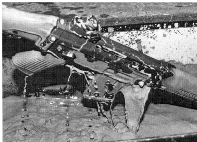
Bild 13: Sturmgewehr 90 im Schlammtest.
