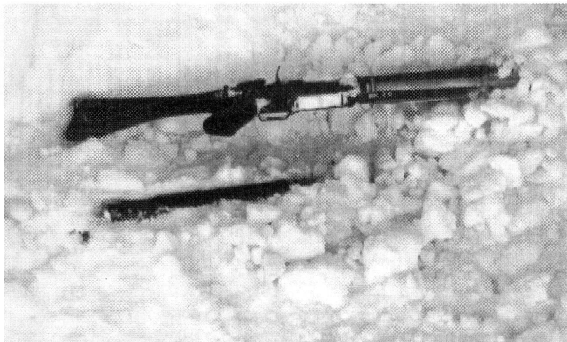
Bild 12: Sturmgewehr 90 im Kältetest, Jungfrau-Joch.
