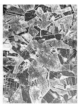
Bild 2b: Mikrogefüge desselben Armreifes. Das Gefüge zeigt, dass die Zinnbronze nach dem Guss geschmiedet und anschliessend nochmals auf mindestens 500 ° C erhitzt worden ist, um die endgültige Form zu erreichen. Hierdurch wurde eine Rekristallisation des ursprünglichen Gussgefüges im festen Zustand hervorgerufen. Zu erkennen sind kleine Einschlüsse von Kupfersulfid, die auf eine Herstellung der Bronze aus sulfidischen Erzen deutet. Massstab: 0,1 mm. Auflicht, geätzt mit Eisenchlorid.
