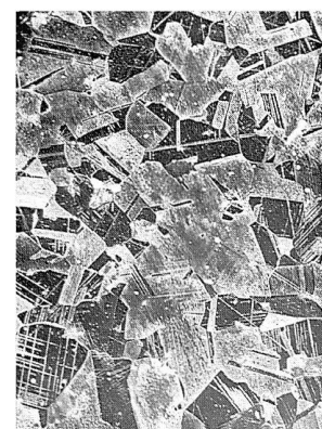
Bild 2b: Mikrogefüge desselben Armreifes. Das Gefüge zeigt, dass die Zinnbronze nach dem Guss geschmiedet und anschliessend nochmals auf mindestens 500 °C erhitzt worden ist, um die endgültige Form zu erreichen. Hierdurch wurde eine Rekristallisation des ursprünglichen Gussgefüges im festen Zustand hervorgerufen. Zu erkennen sind kleine Einschlüsse von Kupfersulfid, die auf eine Herstellung der Bronze aus sulfidischen Erzen deuten. Massstab: 0,1 mm. Auflicht, geätzt mit Eisenchlorid.
