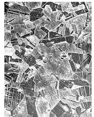
Bild 2b: Mikrogefüge desselben Armreifes. Das Gefüge zeigt, dass die Zinnbronze nach dem Guss geschmiedet und anschliessend nochmals auf mindestens 500 °C erhitzt worden ist, um die endgültige Form zu erreichen. Hierdurch wurde eine Rekristallisation des ursprünglichen Gussgefüges im festen Zustand hervorgerufen. Zu erkennen sind kleine Einschlüsse von Kupfersulfid, die auf eine Herstellung der Bronze aus sulfidischen Erzen deutet. Massstab: 0,1 mm. Auflicht, geätzt mit Eisenchlorid.
