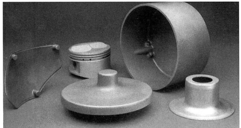
Bild 15. Repräsentative Metall-Matrix-Kompositen (MMC-Materialien). Quelle: Advanced Materials & Processes incl. Metal Progress 2/90.
