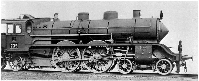
Bild 2: 2'B1'n4v-Schnellzuglokomotive (Gattung II dl der Grossh. Bad. Staatseisenbahn. Erbauer J. A. Maffei, München 1902.
