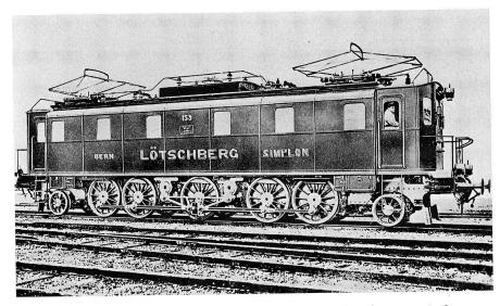
Bild 7: 1 'E1 '-Wechselstromlokomotive der Lötschbergbahn, Erbauer Maschinenfabrik Oerlikon.
