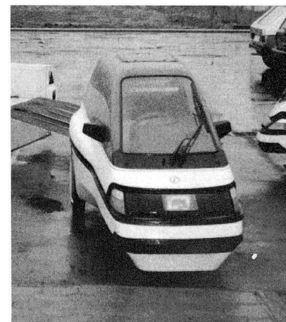
«mini-el»-Fahrzeug mit Thermoplast-Karosserie.
