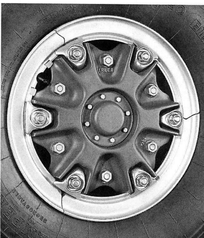
Die segmentierte Felge wird auf dem TRILEX-Rad mit hoher Rundlaufgenauigkeit an einen präzisen Anschlag gespannt.
