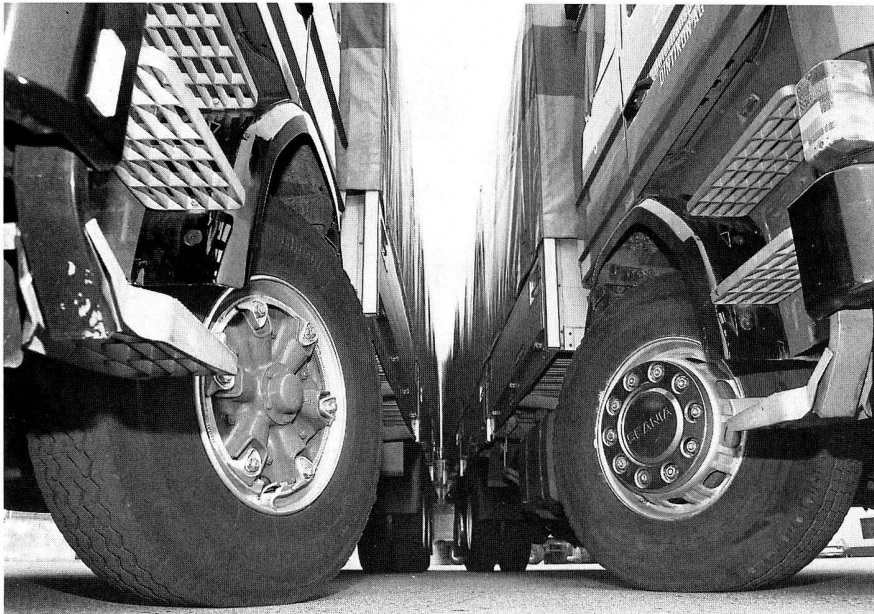
Erst mit dem Übergang auf schlauchlose Reifen nahm der Trend von den Speichenrädern (links TRILEX-Rad) zu den Scheiberrädern (rechts MONOLEX-Rad) in Europa zu.
