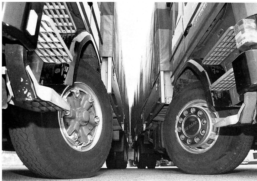
Erst mit dem Übergang auf schlauchlose Reifen nahm der Trend von den Speichenrädern (links TRILEX-Rad) zu den Scheibenrädern (rechts MONOLEX-Rad) in Europa zu.
