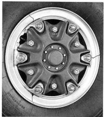
Die segmentierte Felge wird auf dem TRILEX-Rad mit hoher Rundlaufgenauigkeit an einen präzisen Anschlag gespannt.
