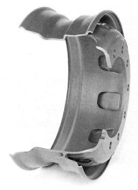
Der Giessprozess erlaubt optimale Formgebung, deshalb sind MONOLEX-Räder leicht, bei hoher Festigkeit.
