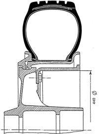
Die seitlich geteilte SIMPLEX-Felge wird, ohne Verwendung von Schrauben, allein durch den Reifendruck auf dem Speichenrad festgehalten.
