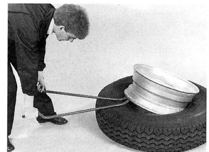
Die einteilige Steilschulter-Tiefbettfelge lässt sich gefahrlos von Hand und am Fließband auch mit automatischen Montagemaschinen in den schlauchlosen Reifen montieren.
