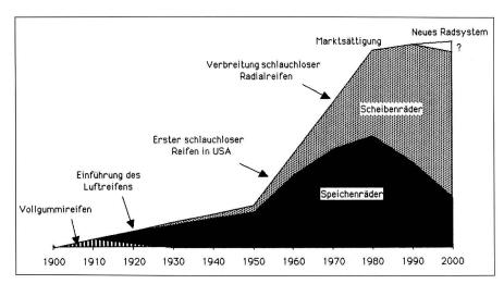
Die Entwicklung der wichtigsten Nutzfahrzeug-Radsysteme im 20. Jahrhundert. Man erkennt die lange Übergangszeit zum schlauchlosen Reifen.
