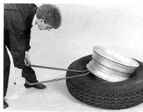
Die einteilige Steilschulter-Tiefbettfelge lässt sich gefahrlos von Hand und am Fliessband auch mit automatischen Montagemaschinen in den schlauchlosen Reifen montieren.
