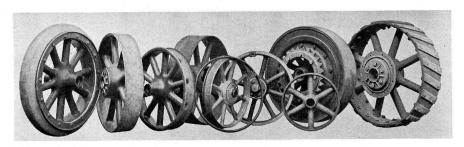
Die Schaffhauser Giesser entwickelten solche Stahlgussräder in den verschiedensten Formen, mit Kreuzspeichen oder noch besser mit hohlen und dadurch leichteren Speichen, wie an dem abgebildeten Sortiment ersichtlich. Solche Räder stellte Georg Fischer 1913 an einer grossen Automobilausstellung im New Yorker Madison Square Garden aus, denn Fischer lieferte damals solche Räder sogar in die USA, unter anderem an die Fifth Avenue Coach Company in New York.
