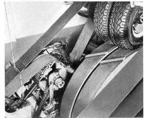
Prüfung der ersten luftbereiften Räder auf dem Georg Fischer Rollprüfstand
