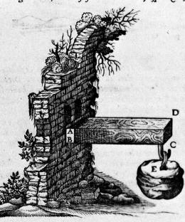
luogo B, done il taglio del muro ferue per fostegno,e la B C per la parte della Leua, doue fi pone la forza, e la groffezza del folido B A elaltraparte della Leua, nella quale è posta la resistenza, che consiste nello staccamento, che s' hà da fare della parte del folido B D, che è
