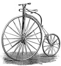
Bild 14: Hochrad aus der Fabrik von Smith, Starley & Co., Coventry. Leistung: «12 to 15 miles per hour». Aus: The Mechanics Magazine; vol. 28, 1872, p. 279.
