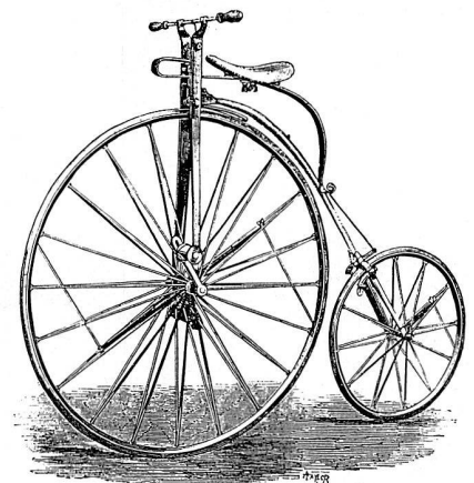
Bild 14: Hochrad aus der Fabrik von Smith, Starley & Co., Coventry. Leistung: «12 to 15 miles per hour». Aus: The Mechanics Magazine; vol. 28, 1872, p. 279.
