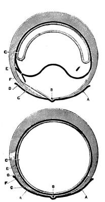
Bild 20: Velomantel und Gummischlauch von Hexles an der «Stanley Exhibition», Dezember 1891. A = Veloreifen, Leinwandstreifen C in B befestigt
