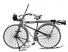
Bild 19: Militärvelo von 1888, mit Gewehrträger, Signallampe, Signalflagge und Ruhestütze. Aus: The Engineer, vol. 65, 1888, p. 161.
