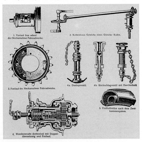
Bild 24: Freilauf (3.1, Übersetzung (1./6.1 und andere «moderne» Fahrradbestandteile. Aus: Meyer's Konversationslexikon, 6. Aufl., Bd. 6, 1905.
