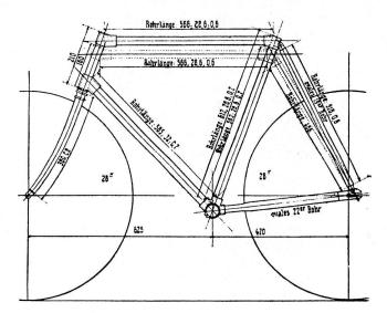
Bild 26: Masstabelle für Herrenräder. Aus: Lexikon der gesamten Technik. Hrsg. O. Lueger, 2. Aufl., Bd. 3, S. 585.
