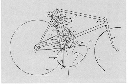
Bild 29: Prototyp eines «Orthopädischen» Pedals. Aus: Bike Tech., vol. 5, 1986, Nr. 3, p. 15.
