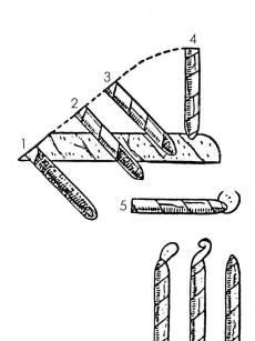
Das «Rollen» eines Deckblatts Ansatz und Einrollen eines A-Fassons: 1–3 Einschlag parallel zu den Blattadern und Einrollen bis zur völligen Einhüllung des Wickels
