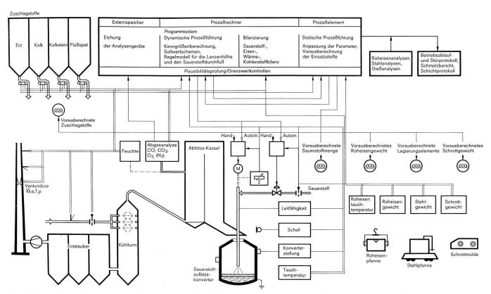
Bild 2: Sauerstoffaufblaskonverter mit den Mess- und Stellgrössen sowie den vom Prozessrechner bearbeiteten Aufgaben
