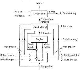
Bild 1: Automatisierungsstufen eines Produktionsprozesses
