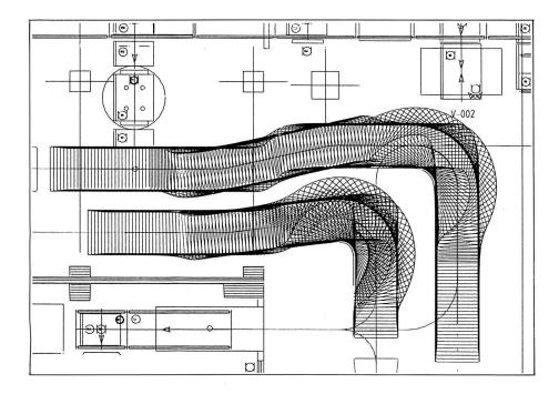
Studien des Raumbedarfs und Kollisionsuntersuchungen für fahrerlose Transportsysteme waren bisher nur im Modellversuch möglich. Heute werden die Fahrbahnen schnell und exakt am Bildschirm ermittelt.
