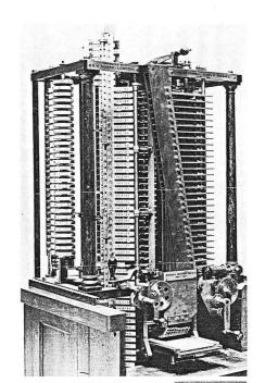
Analytische Maschine mit Ausgabedrucker und Lochkarte zur Steuerung
