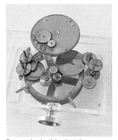
Das griechische Kalenderrechengerät von Antikythera mit dem ältesten nachweisbaren Planetenradgetriebe. Geöffnete Rekonstruktion von D. de Solla-Price, nach Originalfragmenten aus dem 1. Jh. vor Christus
