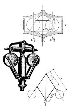
Verschiedene Bauarten und Darstellungsformen von Fliehkraftreglern in Lueger: Lexikon der gesamten Technik, unter dem Schlagwort «Regler», etwa 1908
