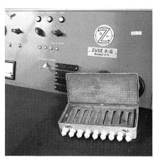
Ausschnitt des Bedienungspultes der Relaisrechenanlage Zuse Z 11 von 1957; davor das Schottsche Rechenkästchen von 1668, mit drehbaren Multiplikationszylindern.
