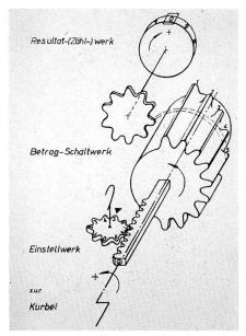
Prinzip einer Stelle mit Staffelwalze in der Leibnizschen Rechenmaschine
