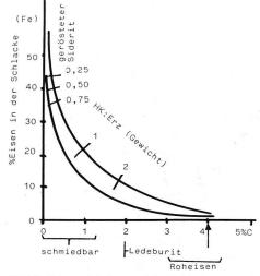
Bild 2: Eisenreduktion und Aufkohlung: Versuche Wraith/Tylecote. Das Diagramm gilt für einen Ofendurchmesser von 23 cm und einer Windeintrittsgeschwindigkeit von etwa 10 m/sec. (Siehe auch Bild 1).
