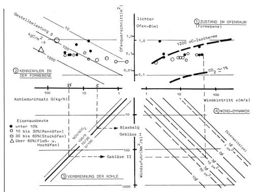
Bild 1: Das Ofendiagramm der Renn-, Stuck- und Flossöfen.
