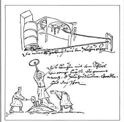
Abbildung 2: Arbeiten beim Stuckofen: Herausziehen des Stuckes mit einer Kette (oben) und Teilen des Stuckes (Halbmasse). Ausschnitt aus einer mit 1613 datierten Zeichnung im Oberösterrichischen Landesarchiv, Linz (Donau). Nach E. Kurzel-Runtscheiner
