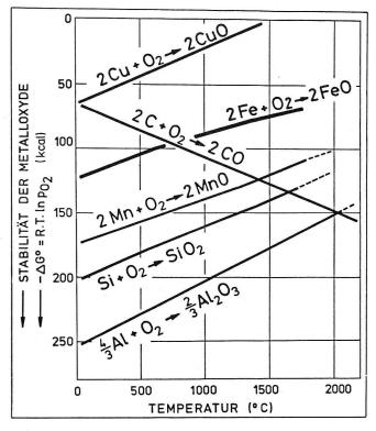
Abbildung 9: Temperaturabhängigkeit der freien Standardbildungsenthalpie △G° einiger Metalloxide und des Kohlenmonoxids (vereinfachte Darstellung). Nach E. Plöckinger und H. Straube¹9
