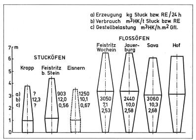
Abbildung 4: Profile und Betriebskennwerte von Stuck- und Flossöfen in Krain kurz vor 1810. Nach F. Marcher<sup>12</sup>
