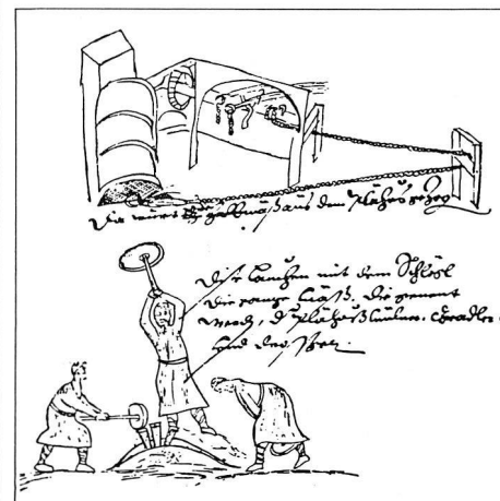
Abbildung 2: Arbeiten beim Stuckofen: Herausziehen des Stuckes mit einer Kette (oben) und Teilen des Stuckes (Halbmasse). Ausschnitt aus einer mit 1613 datierten Zeichnung im Oberösterreichischen Landesarchiv, Linz (Donau). Nach E. Kurzel-Runtscheiner 6
