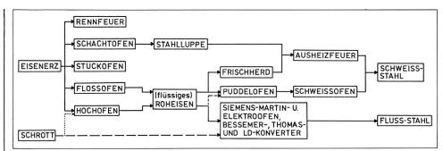
Abbildung 1: Schema der Stahlerzeugung (mit Berücksichtigung älterer Verfahren).
