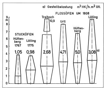
Abbildung 5: Profile von Stuck- und Flossöfen beim Hüttenberger Erzberg (Kärnten). Nach F. Münichsdorfer<sup>13</sup>
